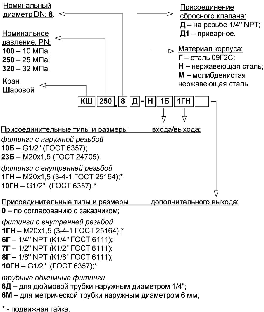
Рисунок 1 – Схема обозначения изделий
