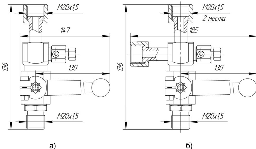
Рисунок 3 – Габаритно-присоединительные размеры КШ250.8Д-Н23Б1ГН (а) и КШ250.8Д-Н23Б1ГН1ГН (б)
