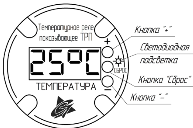
Рисунок 4 – Расположение органов индикации и управления ТРП
